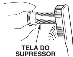
2. Instale o supressor de fagulhas, o protetor do silencioso e o defletor de escapamento na sequência inversa da desmontagem.
