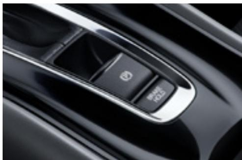
Freio de Estacionamento Eletrônico (EPB) com função Brake Hold
