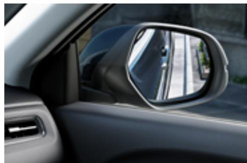
Retrovisores com rebatimento elétrico e função tilt-down
