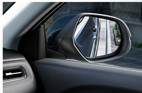
Retrovisores com rebatimento elétrico e função tilt-down
