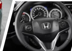
Volante multifuncional com direção elétrica progressiva e revestimento em couro.
