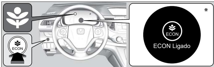
O botão **ECON** liga e desliga o modo ECON. O modo ECON ajuda a melhorar a economia de combustível ajustando o desempenho do motor, da transmissão, do sistema de aquecimento e resfriamento\*/sistema de controle de climatização\* e do controle de velocidade de cruzeiro.
