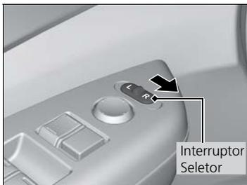
Se ativado, o espelho retrovisor externo do lado do passageiro inclina automaticamente para baixo quando a alavanca seletora for movida para a posição **R**; isto melhora a visibilidade do lado do passageiro quando estiver manobrando o veículo em marcha a ré. O espelho retrovisor retorna automaticamente para a posição original ao mover a alavanca seletora para fora da posição **R**.
