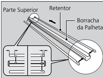
5. Remova os retentores da borracha da palheta que foi removida e instale-os na nova borracha da palheta.
