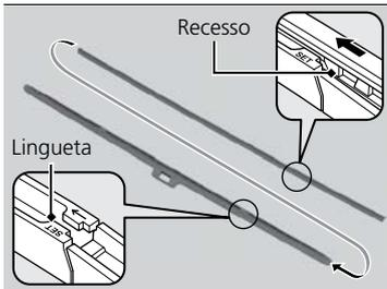
6. Deslize a nova borracha da palheta do limpador sobre o suporte a partir da extremidade inferior.
