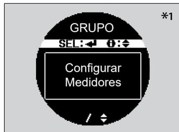
3. Pressione o botão ▲①/▼ até aparecer “**Configurar Medidores**” no display, em seguida pressione o botão **SEL/RESET (Seleção/Ajuste)**.
