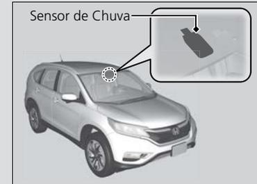
Não coloque a alavanca dos limpadores em **AUTO** quando limpar o para-brisa ou dirigir em um lava-rápido. Se a alavanca do limpador estiver em **AUTO**, e o interruptor de ignição\* na posição **LIGADA III**\*<sup>1</sup>, o sensor de chuva poderá reagir à sua mão ou água, e os limpadores poderão ligar automaticamente.
