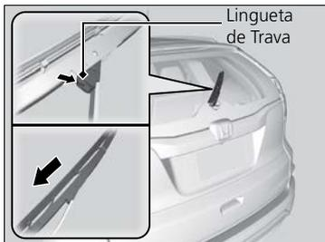
2. Pressione a lingueta de trava e deslize a palheta para fora do braço do limpador.
