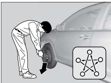
5. Abaixe o veículo e remova o macaco. Aperte as porcas da roda na ordem indicada pela figura. Aperte as porcas duas ou três vezes nessa ordem.
