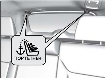
Existem dois pontos de ancoragem localizados no teto, na parte traseira nas posições externas do banco traseiro. Um sistema de proteção infantil instalado com cinto de segurança, que seja equipado com trava, pode ser usado para segurança adicional.
