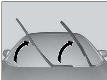
1. Levante primeiro o braço do limpador do lado do motorista e, em seguida, do lado do passageiro.
