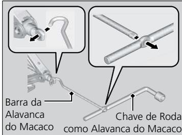
6. Levante o veículo, usando a barra da alavanca do macaco e a chave de roda como alavanca, até que o pneu esteja fora do chão.
