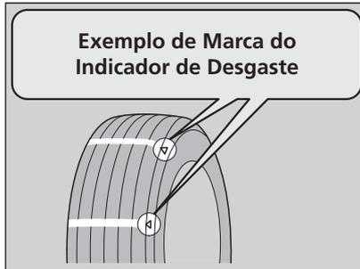
A ranhura em que o indicador de desgaste está localizado é 1,6 mm mais rasa do que em qualquer outro lugar no pneu. Se a banda de rodagem estiver gasta de forma a expor o indicador, substitua o pneu. **Pneus com desgaste excessivo não oferecem boa tração em pistas molhadas.**
