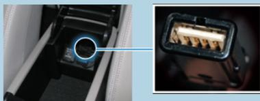
2. Encaixe o conector do USB ao conector do iPod ou dispositivo de memória.
