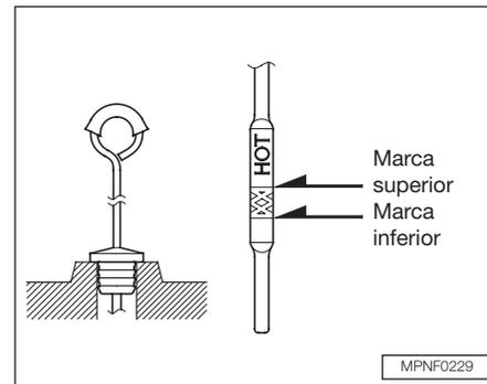
3. Insira a vareta medidora totalmente, conforme indicado na ilustração.
