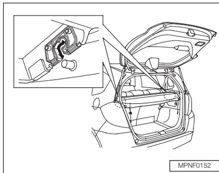
Para remover a cobertura, retire os ganchos da tampa traseira, deslize a cobertura para a direção da traseira do veículo, depois levante-a diretamente para cima.
