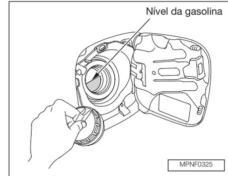
4. Abasteça lentamente e com cuidado o reservatório de gasolina. Inspeção o nível de combustível através da abertura no bocal durante o abastecimento do reservatório de gasolina.
