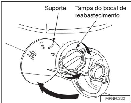
4. Remova lentamente a tampa de abastecimento de combustível. Você pode ouvir um assobio conforme a pressão interna escapa do reservatório principal. Coloque a tampa no suporte existente na portinhola de abastecimento de combustível.
