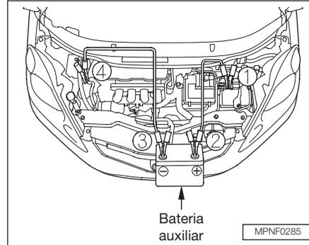
Os números na ilustração acima indicam a sequência para conectar os cabos auxiliares. Para desconectar os cabos proceda na ordem inversa.
