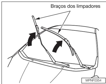
1. Levante os braços dos limpadores, separando-os do para-brisa. Levante primeiro o limpador do para-brisa do lado do motorista e depois o limpador do lado do passageiro.
