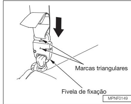
Alinhe a marca triangular da lingueta menor com a marca triangular da fivela de fixação ao inserir a lingueta na fivela.
