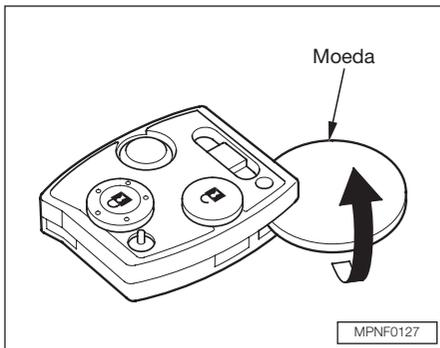
3. Dentro do controle, separe a tampa interna da base com os botões cuidadosamente com a borda de uma moeda.
