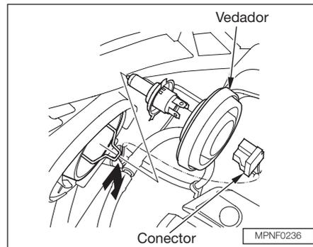
1. Remova o conector elétrico da lâmpada, puxando o conector para trás.
