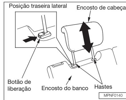
Para remover o encosto de cabeça dianteiro ou o traseiro lateral para limpeza ou reparo, puxe-o para cima, até o máximo que ele puder ir. Pressione o botão de liberação e remova o encosto de cabeça para fora do encosto do banco.
