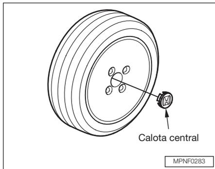
16. Remova a calota central antes de guardar a roda com o pneu furado, no alojamento do estepe.
