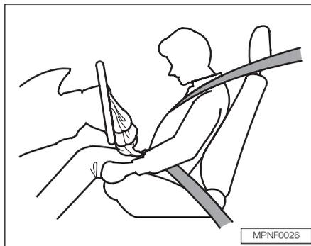
Após o airbag inflar, começará a esvaziar-se imediatamente, e não interferirá, portanto, em sua visibilidade para operar outros controles. O tempo total para inflar e esvaziar é uma fração de segundo. O acionamento do airbag pode até nem ser notado.
