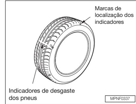
Os pneus de seu veículo possuem indicadores de desgaste nas bandas de rodagem.
