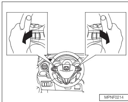
Para engatar uma marcha superior ou inferior, use os seletores + ou -, localizados à direita e à esquerda, respectivamente, no volante de direção.
