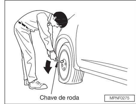
8. Solte as quatro porcas, 1/2 volta, com a chave de roda.
