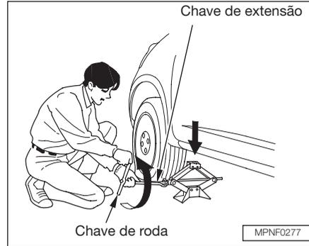
10. Use a chave de roda e a extensão, como mostra a ilustração, para levantar o veículo, até o pneu furado se afastar do chão.
