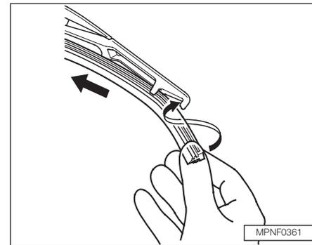
5. Deslize a palheta nova para dentro do suporte. Certifique-se de que ela fique encaixada nos orifícios ao longo de todo o comprimento.
