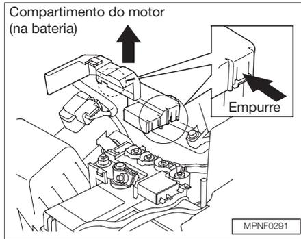
A caixa de fusíveis está localizada na parte de trás do compartimento do motor, lado do motorista. Para abrir, pressione as linguetas, conforme indicado na ilustração.
