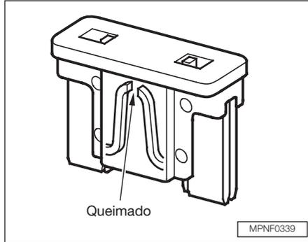
6. Verifique se o filamento está rompido. Se estiver, substitua o fusível por um novo de mesma amperagem ou inferior.
