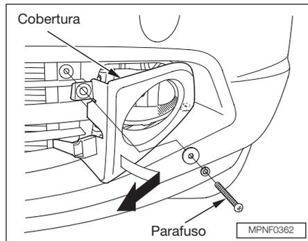
1. Para remover a cobertura do farol de neblina dianteiro, use uma chave Philips para remover o parafuso. Puxe o parafuso lateral da cobertura do farol de neblina e então puxe-o cuidadosamente para fora do para-choque.
