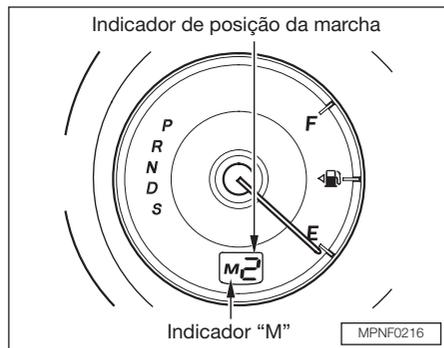
Ao mover a alavanca seletora de “D” para “S” e puxar qualquer seletor de marchas, o indicador de posição da marcha mostra “M” junto com o número da marcha selecionada.
