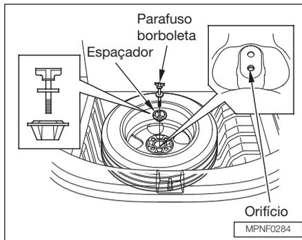
17. Coloque a roda com o pneu furado no alojamento do estepe, voltada para baixo.
