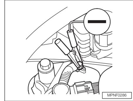
4. Conecte outro cabo no terminal negativo (-) da bateria auxiliar. Conecte a outra extremidade desse cabo no ponto terra, como indica a figura. Não conecte esse cabo em qualquer outra peça do motor.
