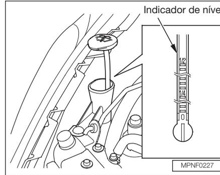
Verifique o nível do fluido no reservatório, removendo a tampa e olhando no indicador de nível fixado à tampa.
