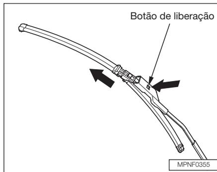
2. Desconecte o conjunto da palheta do braço do limpador, pressionando o botão de liberação. Depois deslize o conjunto da palheta para fora do braço do limpador.
