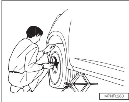
13. Instale o estepe. Coloque as porcas da roda, dando aperto com a mão. Depois dê o aperto em cruz, com a chave de roda, até a roda ficar firme junto ao cubo da roda. Não dê aperto total.
