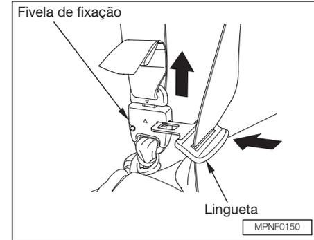
Para destravar a fixação destacável, insira a lingueta no alojamento, localizado na lateral da fivela de fixação. Guarde a fixação destacável e a lingueta do cinto de segurança no alojamento do retrator.
