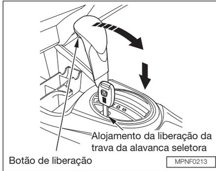
6. Remova a chave de ignição do alojamento da liberação da trava da alavanca seletora, em seguida reinstale a cobertura do alojamento. Certifique-se de encaixar corretamente o lado esquerdo da cobertura. Pressione o pedal do freio e dê a partida no motor.
