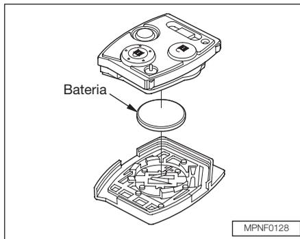
4. Remova a bateria da cobertura interna e coloque a nova com o símbolo “+” voltado para baixo.
