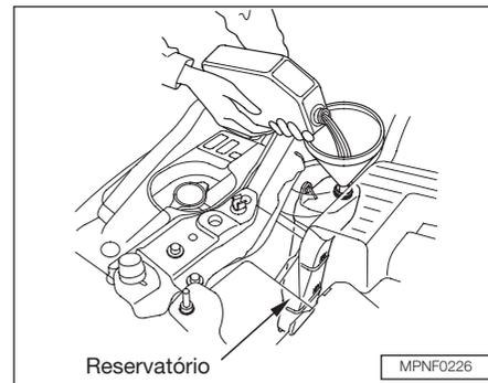
6. Em seguida, adicione líquido de arrefecimento no reservatório até que o nível esteja entre as marcas MAX. e MIN. Reinstale a tampa no reservatório.
