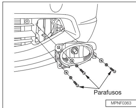
2. Para remover o conjunto do farol de neblina, use uma chave Philips para remover os parafusos e depois cuidadosamente puxe o conjunto para fora do para-choque.
