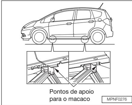
9. Localize o ponto de apoio mais próximo do pneu que será trocado. Coloque o macaco sob este ponto. Gire a extremidade do suporte do macaco no sentido horário, até a base superior do macaco encostar no ponto de apoio. Verifique se a ranhura do ponto de apoio na carroceria está junto da base superior do macaco.
