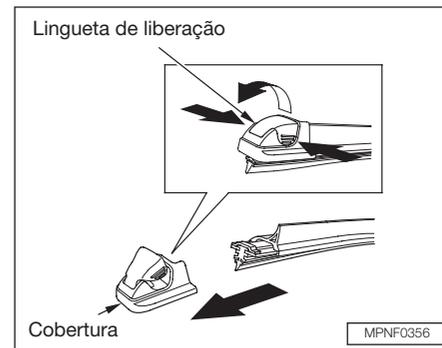
3. Empurre a lingueta de liberação da cobertura para até a extremidade do conjunto da palheta, para remover a cobertura.
