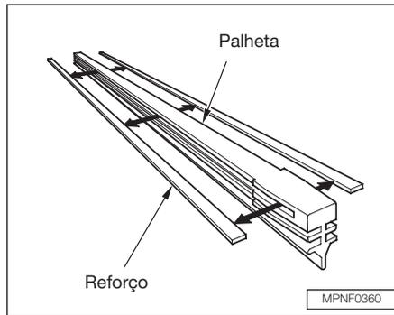
4. Examine a nova palheta do limpador. Se ela não tem nenhum reforço de metal ou plástico ao longo da parte de trás, remova o reforço de metal da palheta do limpador velha e instale-o ao longo dos orifícios da nova palheta.
