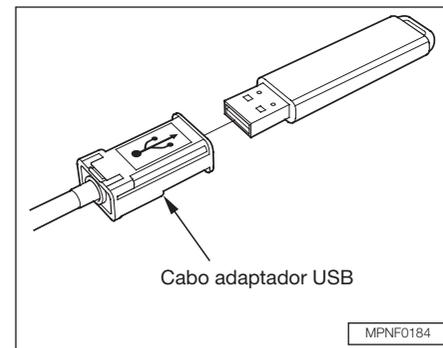
2. Conecte o conector do dispositivo de memória flash USB ao cabo adaptador USB corretamente e com firmeza.
