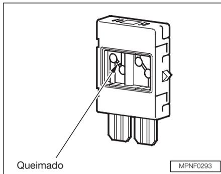
4. Verifique os fusíveis maiores da caixa de fusíveis, no interior do veículo. Remova-os com o extrator de fusíveis, localizado dentro da caixa de fusíveis do interior do veículo.
