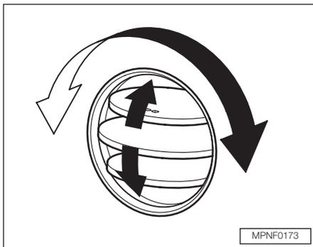
Para ajustar o fluxo de ar, pressione a borda para abrir e depois movimente o difusor de ar para cima e para baixo e gire-o.
