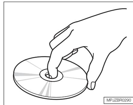
Manuseie um disco pelas bordas; nunca toque a superfície. Nunca coloque anéis estabilizadores ou etiquetas sobre o disco.
