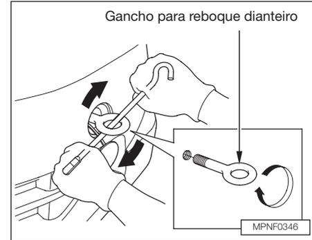
3. Rosqueie o gancho para reboque dianteiro no orifício, localizado no para-choque, e aperte o gancho firmemente com a extensão.
