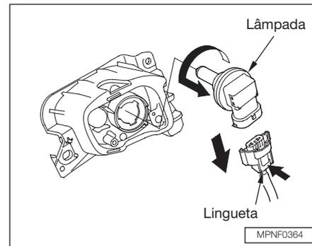
3. Remova o conector da lâmpada pressionando a lingueta e empurrando o conector para baixo.
