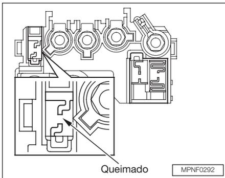
3. Verifique os fusíveis maiores da caixa de fusíveis do compartimento do motor e observe os filamentos. A substituição desses fusíveis deve ser feita em uma Concessionária Autorizada Honda.
