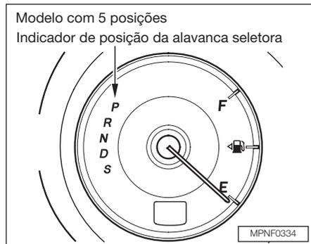
O indicador **D** acende por alguns segundos, quando a ignição é ligada. Se ele piscar com o veículo em movimento (em qualquer marcha), indica um possível problema na transmissão. Evite aceleração rápida e leve o veículo a uma Concessionária Autorizada Honda para inspeção, o mais rápido possível.
