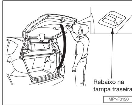
Para fechar a tampa traseira, segure no rebaixo da tampa traseira e abaixe a tampa, depois pressione a tampa pela extremidade traseira.
