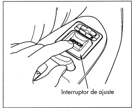
3. Pressione a extremidade apropriada do interruptor de ajuste para mover o espelho para direita ou esquerda e para cima ou para baixo.
