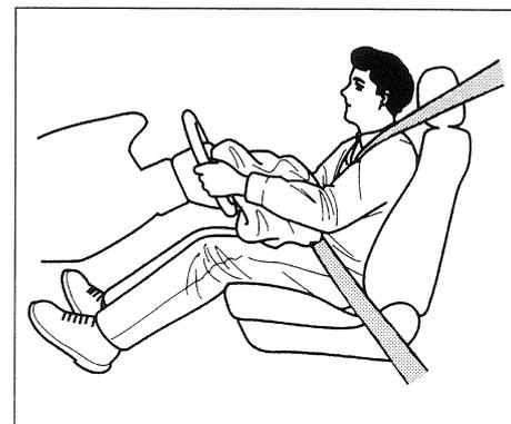
Após o airbag inflar-se, começará a esvaziar-se imediatamente, não interferindo, portanto, em sua visibilidade para operar outros controles. O tempo total para inflar e esvaziar é uma fração de segundo. O acionamento do airbag pode até nem ser notado.
