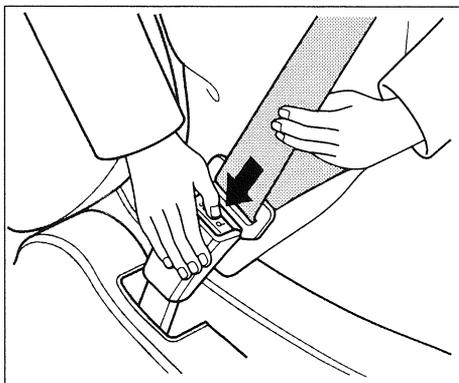
6. Para destravar o cinto de segurança, pressione o botão vermelho da fivela. Em seguida, conduza o cinto em direção à coluna da porta.
