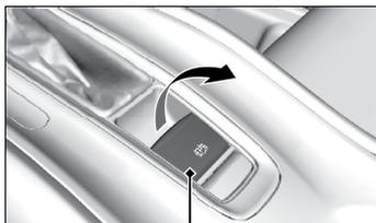
Interruptor do Freio de Estacionamento com Acionamento Elétrico
