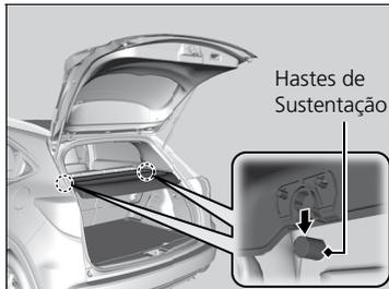
3. Desencaixe as hastas de sustentação e, em seguida, remova a cobertura do compartimento de bagagem.
