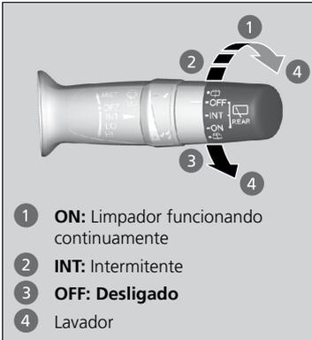
Os limpador e lavador do vidro traseiro pode ser usado quando o interruptor de ignição estiver na posição **LIGADA III**.
