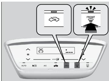
Ao selecionar o ícone
