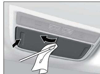
1. Empurre a lente na direção oposta que estava substituindo.
