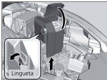
Puxe para cima a tampa do terminal ⊕ e, em seguida, remova a cobertura, empurrando a lingueta, como indicado.
