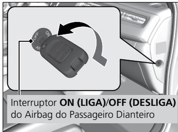
Interruptor **ON (LIGA)/OFF (DESLIGA)** do Airbag do Passageiro Dianteiro
