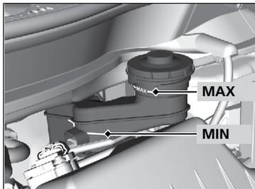
O nível do fluido deverá estar entre as marcas **MIN** e **MAX** na lateral do reservatório.
