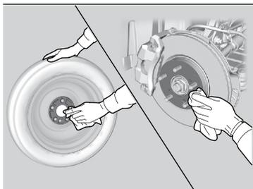
2. Limpe as superfícies de instalação da roda com um pano limpo.
