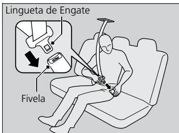
3. Insira a lingueta de engate na fivela. Coloque adequadamente o cinto de segurança, da mesma forma que é colocado o cinto de segurança de três pontos.
