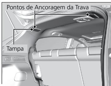
Existem dois pontos de ancoragem localizados no teto, na parte traseira nas posições externas do banco traseiro. Um sistema de proteção infantil instalado com cinto de segurança, que seja equipado com trava, pode ser usado para segurança adicional.
