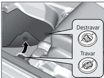
O tapete do motorista é fixado às ancoragens do assoalho, impedindo que escorregue para a frente. Para remover o tapete para limpeza, gire os botões de ancoragem para a posição de destravamento, como indicado na figura.
