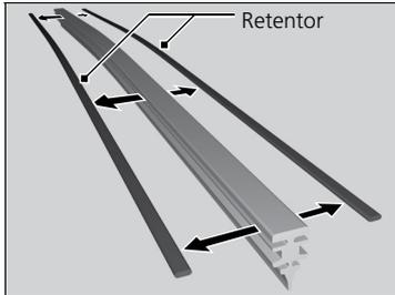
4. Remova os retentores da borracha da palheta que foi removida e instale-os na nova borracha da palheta.
