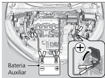
1. Conecte primeiro o cabo auxiliar ao terminal  $\oplus$  da bateria descarregada.
