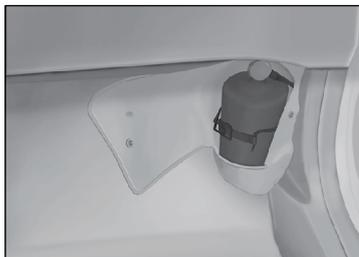
O extintor de incêndio está localizado sob o painel de instrumentos, no lado do passageiro dianteiro, fixado à carroçaria do veículo.
