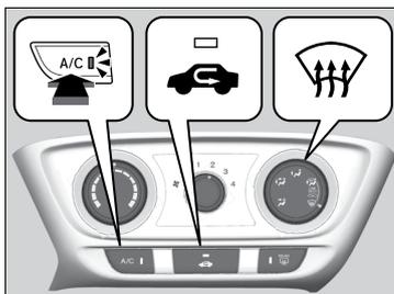
1. Ajuste o ventilador para velocidade máxima.
