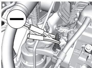
4. Conecte a outra extremidade do segundo cabo auxiliar ao parafuso de fixação do motor (ponto terra), como mostrado. Não conecte esse cabo em qualquer outra parte do motor.
