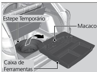
2. Retire a caixa de ferramentas do compartimento de bagagem.
