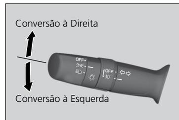
Os sinalizadores de direção poderão ser usados quando o interruptor de ignição estiver na posição **LIGADA III**.
