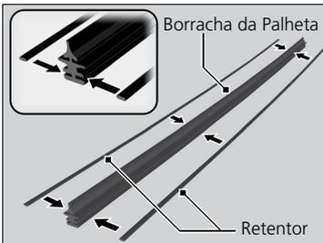
3. Pressione os retentores para destravar os recessos e então, deslize a borracha da palheta do limpador para fora do suporte, empurrando a extremidade da lingueta para fora.
