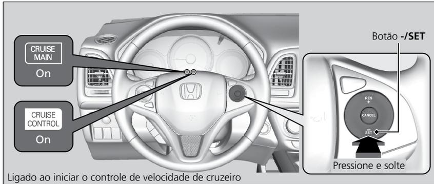
Ao atingir a velocidade desejada, pressione o botão **-/SET** e solte o pedal do acelerador. No momento em que o botão **-/SET** for liberado, a velocidade será fixada e o controle de velocidade de cruzeiro será acionado. O indicador **CRUISE CONTROL** se acenderá.
