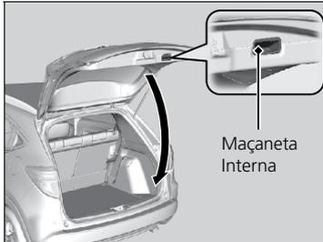
Ao destravar todas as portas, a tampa traseira será destravada. Pressione o botão de abertura da tampa traseira e levante a tampa traseira.
