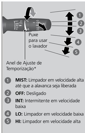
Os limpadores e lavadores do para-brisa podem ser usados quando o interruptor de ignição estiver na posição **LIGADA** [II].
