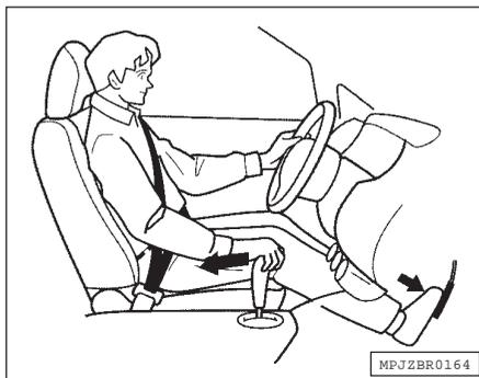
Para retornar a alavanca seletora para a posição **P**, pressione também o botão de liberação. Para evitar danos à transmissão, somente coloque a alavanca seletora na posição **P** quando o veículo estiver totalmente parado. Para remover a chave da ignição, a alavanca seletora deve estar na posição **P**.
