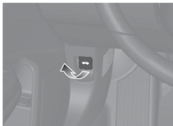
**1** Puxe a alavanca de abertura do capô no canto esquerdo inferior do painel de instrumentos.
