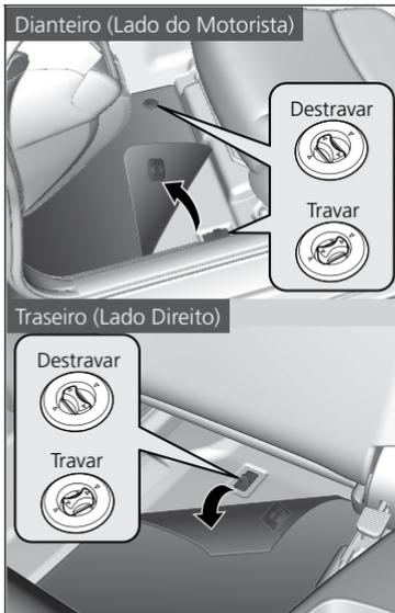
O tapete do motorista e do passageiro traseiro do lado direito são fixados às ancoragens do assoalho, impedindo que escorregue para a frente. Para remover os tapetes para limpeza, gire os botões de ancoragem para a posição de destravamento, como indicado na figura. Ao reinstalar os tapetes após a limpeza, posicione-os corretamente e gire os botões de ancoragem para a posição de travamento, como indicado na figura.
