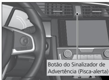
Pressione o botão localizado acima do sistema de áudio, no painel de instrumentos, para acionar o sinalizador de advertência. Todos os sinalizadores externos e luzes indicadoras no painel de instrumentos piscarão, enquanto o sinalizador de advertência permanecer acionado. Para desligar, pressione o botão novamente.
