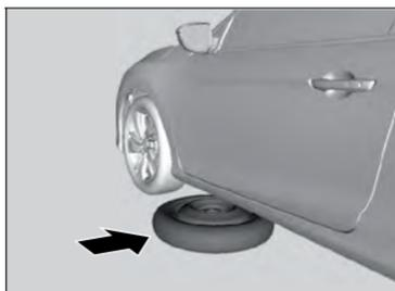
6. Coloque o estepe temporário (lado da roda para cima) embaixo da carroceria do veículo, próximo ao pneu a ser substituído.
