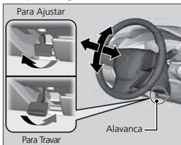
1. Puxe a alavanca de ajuste do volante de direção na sua direção.
