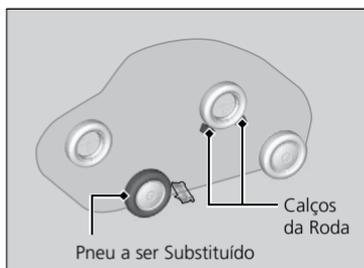
5. Coloque um calço na frente e atrás da roda diagonalmente oposta ao pneu furado.
