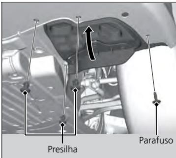
1. Remova as presilhas usando uma chave de fenda, remova o parafuso e empurre o protetor interno para cima.
