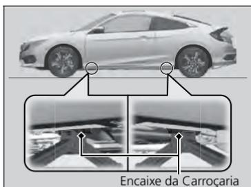
1. Coloque o macaco sob o encaixe da carroceria mais próximo ao pneu a ser substituído.
