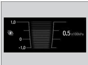
Quando o turbocompressor está produzindo pressão, este medidor exibe a pressão do turbocompressor.
