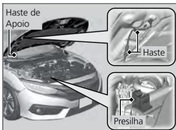
4. Remova a haste de apoio da presilha. Coloque-a no orifício de apoio do capô. Para fechar o capô, levante-o levemente para soltar a haste de apoio do seu orifício. Encaixe novamente a haste de apoio em sua presilha. Abaixei o capô até aproximadamente 30 cm do fechamento e solte-o, para que ele feche e trave através da ação do seu próprio peso. Após o fechamento do capô, verifique se ele está seguramente travado.
