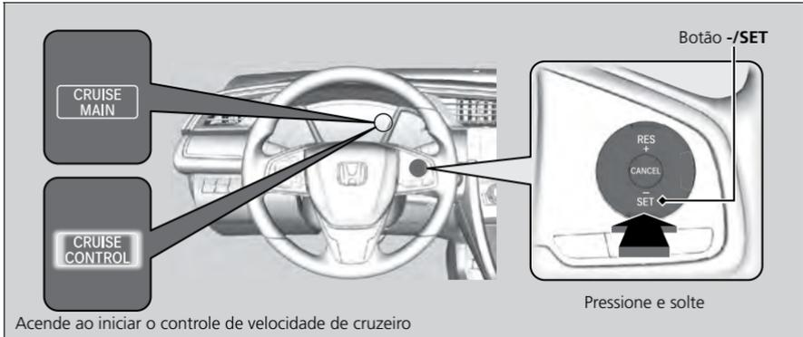
Ao atingir a velocidade desejada, pressione o botão **-/SET** e solte o pedal do acelerador. No momento em que o botão **-/SET** for liberado, a velocidade será fixada e o controle de velocidade de cruzeiro será iniciado. O indicador **CRUISE CONTROL** aparece na interface de informações ao motorista.
