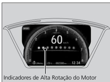
Se acende da esquerda para a direita de acordo com a rotação do motor.
