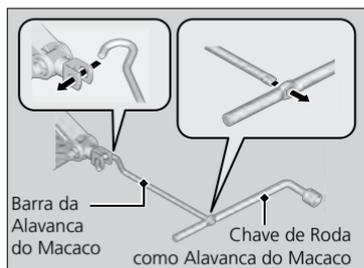
3. Levante o veículo, usando a barra da alavanca do macaco e a chave de roda como alavanca, até que o pneu esteja fora do chão.
