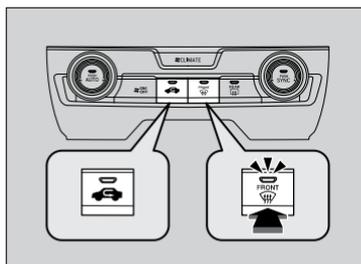
Ao pressionar o botão (desembaçador do para-brisa) o sistema aciona o ar-condicionado e alterna automaticamente para o modo de entrada de ar externo.
