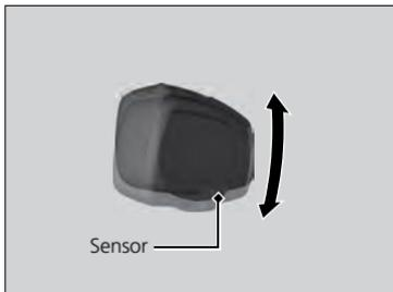
Ao dirigir após escurecer, o espelho retrovisor interno com antiofuscamento automático reduz o reflexo dos veículos que trafegam atrás de você, baseado nas entradas do sensor do retrovisor interno. Esta função está sempre ativada.
