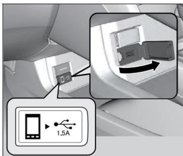
Instale o conector do iPod® ou o dispositivo USB no conector USB.
