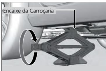
2. Gire a extremidade do suporte do macaco no sentido horário, como indicado na figura, até a base superior do macaco encostar no encaixe da carroceria.
