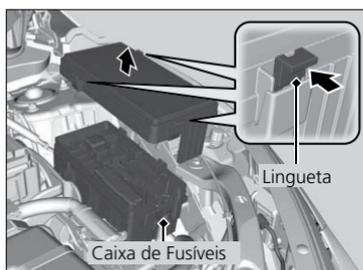
Localizada próxima da bateria. Empurre as linguetas para remover a tampa.
