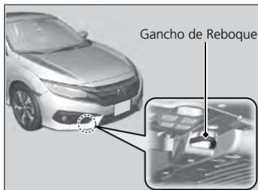
1. Fixe o dispositivo de reboque ao gancho de reboque.
