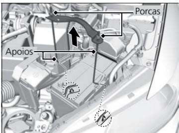
2. Solte a porca situada no cabo negativo da bateria, depois desconecte o cabo do terminal negativo (-).
