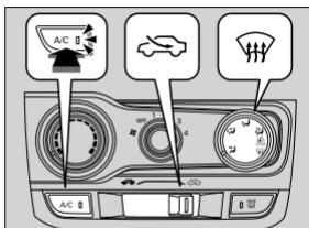
1. Ajuste o ventilador em alta velocidade.
