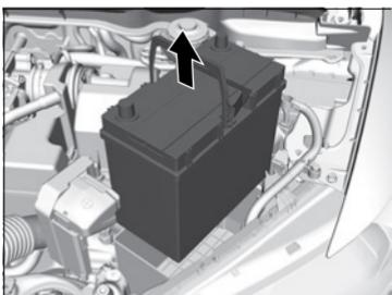
5. Puxe a parte inferior do apoio da bateria para fora do orifício na base da bateria e retire o suporte em conjunto com os apoios.
