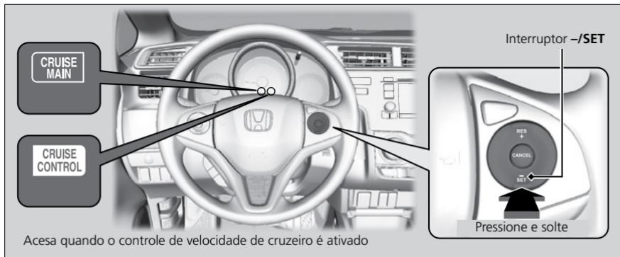
Tire o pé do pedal e pressione o interruptor **-/SET** quando alcançar a velocidade desejada. Quando soltar o interruptor **-/SET**, a velocidade determinada será fixada, e o controle de velocidade de cruzeiro será ativado. O indicador **CRUISE CONTROL** acende.
