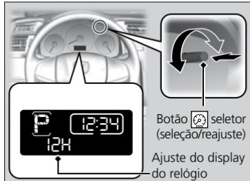
1. Pressione o botão seletor
