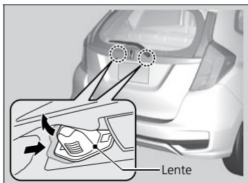
1. Empurre a lente para a direita e depois puxe-a junto com o soquete fixado a ela.
