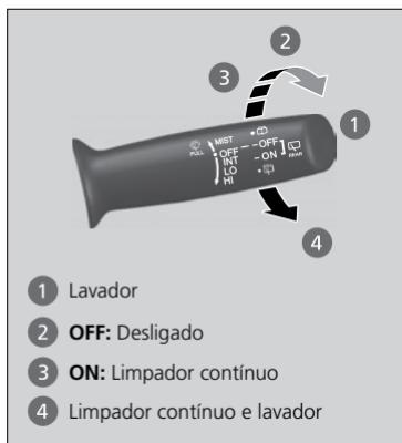
O limpador e lavador do vidro traseiro podem ser usados quando o interruptor de ignição está na posição **LIGADA**
