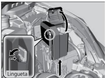
Puxe a tampa no terminal  $\oplus$  e, depois, remova-a puxando a lingueta conforme mostrado.
