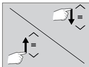
As configurações do controle de temperatura e do ventilador podem ser ajustadas deslizando o dedo entre os ícones de seta para cima e para baixo.
