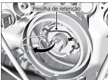
3. Retire a presilha de retenção e depois a lâmpada.
