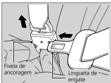
Para destravar a ancoragem destacável, introduza a lingueta de engate na fenda ao lado da fivela de ancoragem.
