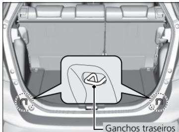
Os ganchos para bagagem no assoalho do compartimento de bagagem podem ser usados para instalar uma rede para prender objetos.
