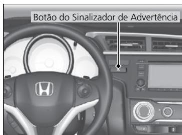
Pressione o botão localizado à esquerda do sistema de áudio, no painel de instrumentos, para acionar o sinalizador de advertência. Todos os sinalizadores externos e luzes indicadoras no painel de instrumentos piscarão, enquanto o sinalizador de advertência permanecer acionado. Para desligar, pressione o botão novamente.
