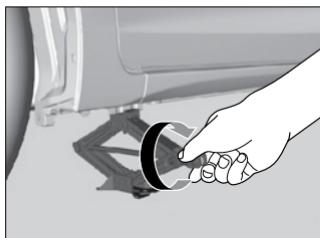
2. Gire a extremidade do suporte do macaco no sentido horário, conforme mostrado, até que a parte superior do macaco encoste no encaixe da carroçaria.
