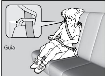
Existe um encosto disponível para um assento de elevação específico. Instale o encosto no assento de elevação e ajuste-o ao banco do veículo de acordo com as instruções do fabricante do assento de elevação. Certifique-se de que o cinto de segurança seja corretamente passado através da guia no ombro do encosto e que o cinto não toque nem cruze o pescoço da criança.
