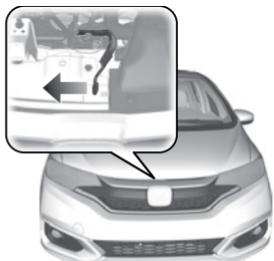
**2** Localize a alavanca de trava do capô, mova-a como indicado na figura e levante o capô. Depois de levantar o capô um pouco, você pode liberar a alavanca.
