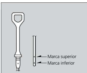
4. Retire o medidor de nível novamente e verifique o nível de óleo. Ele deve estar entre as marcas superior e inferior. Adicione óleo, se necessário.
