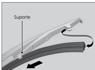
3. Deslize a borracha da palheta do limpador sobre o suporte e desencaixe a extremidade.
