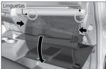
2. Solte as duas linguetas pressionando-as em ambos os painéis laterais.
