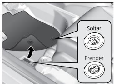
O tapete do motorista é preso às fixações do assoalho, o que impede o deslizamento para frente. Para retirar o tapete para limpeza, gire os botões de ancoragem para a posição de travamento. Ao recolocar o tapete depois da limpeza, gire os botões de ancoragem para a posição de destravamento.
