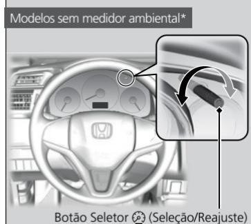
Quando as lanternas dianteiras estão acesas e o interruptor de ignição está na posição **LIGADA** , é possível usar o botão seletor (Seleção/Reajuste) para ajustar a luminosidade do painel de instrumentos.
