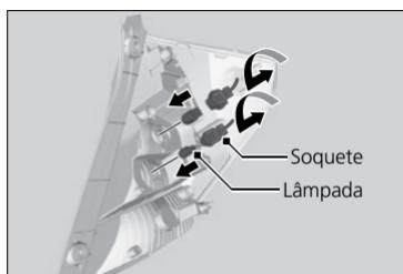
3. Gire o soquete para a esquerda para retirá-lo. Retire a lâmpada usada.
