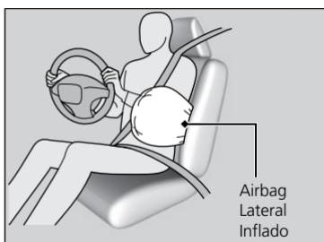
Quando os sensores detectam um impacto lateral de moderado a severo, a unidade de controle envia um sinal ao airbag lateral do lado do impacto para inflar imediatamente.
