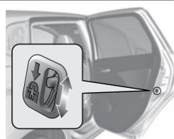
Para desativar essa função, empurre a alavanca para a posição destravada.
