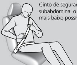
3. Posicione o cinto subabdominal na posição mais baixa possível sobre o quadril e puxe o cinto transversal para cima de forma a ajustar confortavelmente o cinto subabdominal. Isso permite que os fortes ossos pélvicos absorvam o impacto de uma colisão, reduzindo a probabilidade de lesões internas.
