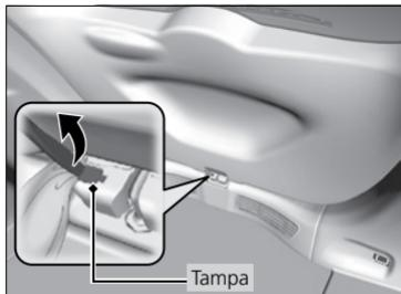
1. Enrole um pano na ponta de uma chave de fenda. Insira-a na tampa, conforme mostrado na imagem, e abra a tampa.
