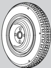
Use o estepe temporário (compacto) somente para substituição temporária. Leve o pneu padrão para conserto ou substituição e instale-o novamente no veículo o mais rápido possível.
