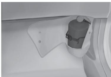
Caso deseje instalar o extintor de incêndio, o local ideal para sua instalação é sob o painel de instrumentos, no lado do passageiro dianteiro, fixado à carroceria do veículo.
