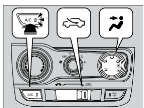
1. Selecione a velocidade do ventilador usando o botão de controle do ventilador.
