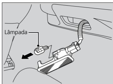
2. Retire a lâmpada usada e insira uma lâmpada nova.
