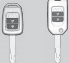
Use a chave para ligar e desligar o motor e para travar e destravar todas as portas do veículo e a tampa traseira. Também é possível usar o controle remoto para travar e destravar as portas do veículo e a tampa traseira.
