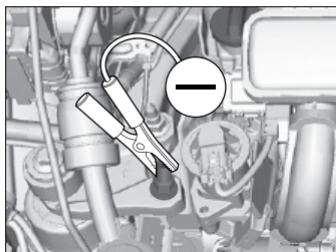
1. Conecte o primeiro cabo auxiliar ao terminal
