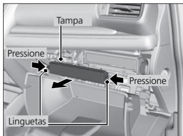
4. Pressione as linguetas nos cantos da tampa da caixa do filtro e retire a tampa.
