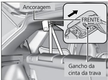
Existem dois pontos de ancoragem localizados no teto para as posições dos assentos laterais traseiros. Se o sistema de proteção infantil estiver equipado com uma trava, mas puder ser instalado com o cinto de segurança, a trava poderá ser utilizada para segurança extra.
