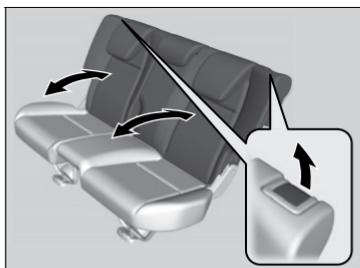
Puxe a alavanca à direita para alterar o ângulo da metade direita do encosto e a alavanca à esquerda para ajustar a metade esquerda.
