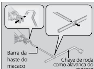
3. Levante o veículo, usando a barra da haste do macaco e a alavanca do macaco, até que o pneu esteja suspenso.
