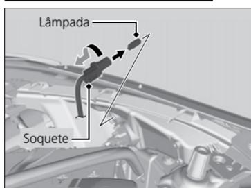
1. Gire o soquete para a esquerda e retire-o, depois retire a lâmpada usada.
