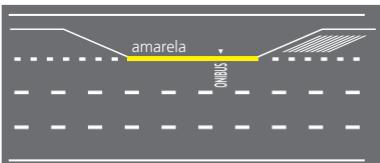
MARCA DELIMITADORA PARA PARADA DE ÔNIBUS COM SUPPRESSÃO DE PARTE DA MARCAÇÃO
