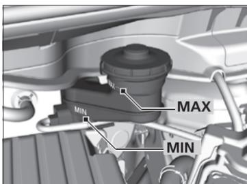
O nível do fluido de freio deve estar entre as marcas **MÍN** e **MÁX** na lateral do reservatório.
