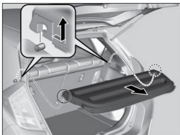
3. Desconecte os pinos de suporte e depois remova a tampa do compartimento de bagagem.
