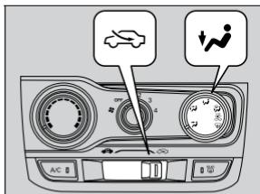
O aquecedor usa o calor do líquido de arrefecimento do motor para aquecer o ar.
