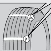
A ranhura onde o indicador de desgaste está localizado é 1,6 mm mais rasa que as outras regiões do pneu. Se a banda de rodagem estiver desgastada de modo a deixar o indicador exposto, substitua o pneu. **Pneus desgastados têm menor atrito em pistas molhadas.**
