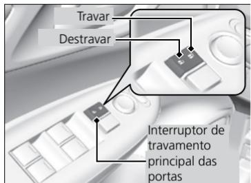
Aperte o interruptor de travamento principal das portas, conforme mostrado na figura, para travar ou destravar todas as portas do veículo e a tampa traseira.
