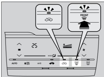
Toque no ícone para ligar o sistema de ar-condicionado e colocar o sistema no modo de ar fresco automaticamente.
