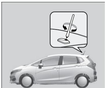
Seu veículo é equipado com uma antena de teto removível.
