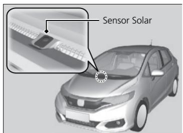
O sistema de climatização automática possui sensores. Não cubra esses sensores nem derrame líquidos sobre eles.
