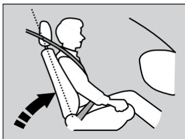
Coloque o encosto do banco do motorista na vertical, numa posição confortável, deixando bastante espaço entre o seu tórax e a tampa do airbag no centro do volante de direção.
