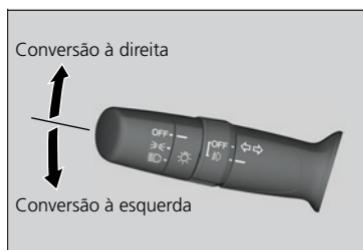
Os sinalizadores de direção podem ser usados quando o interruptor de ignição estiver na posição **LIGADA**
