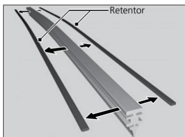
5. Retire os retentores da palheta de borracha substituída e monte-os na nova palheta do limpador.
