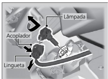
3. Pressione a lingueta para remover o acoplador.
