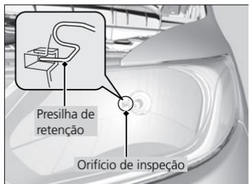
5. Recoloque a presilha de retenção. Prenda a extremidade da presilha em volta do pino de fixação.
