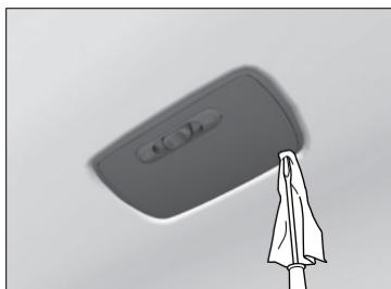
1. Para remover a tampa, force sua borda usando uma chave de fenda.
