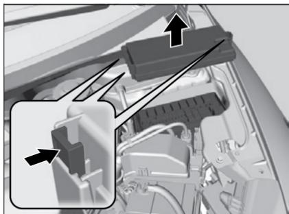
Situada próximo ao reservatório do fluido de freio. Empurre as linguetas para abrir a caixa. As localizações dos fusíveis são mostradas na figura a seguir. Localize o fusível correspondente pelo número do fusível e número da figura da caixa de fusíveis.
