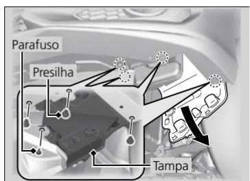
1. Remova os parafusos usando uma chave Phillips e remova as presilhas de fixação usando uma chave de fenda pequena.
