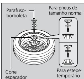
2. Remova o cone espaçador do parafuso-borboleta, vire-o de cabeça para baixo e insira-o de volta no parafuso. Prenda o pneu furado com o parafuso-borboleta.
