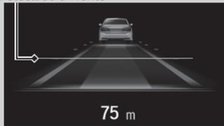
ACC com Assistente de Condução em Baixa Velocidade ativado: A área atrás do ícone do veículo fica verde.
