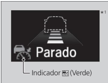
Se nenhum veículo estiver à sua frente antes de retomar a condução do veículo, ao pressionar o pedal do acelerador, o ACC com Assistente de Condução em Baixa Velocidade começará a operar novamente dentro da velocidade definida anteriormente.
