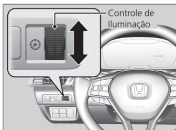
Quando o modo de alimentação está no modo **LIGADO**, você pode usar o controle de iluminação para ajustar a iluminação do painel de instrumentos.
