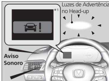
Mesmo se a distância definida entre o seu veículo e o veículo detectado à frente for curta, o ACC com Assistente de Condução em Baixa Velocidade pode começar a acelerar o seu veículo nas seguintes circunstâncias:
