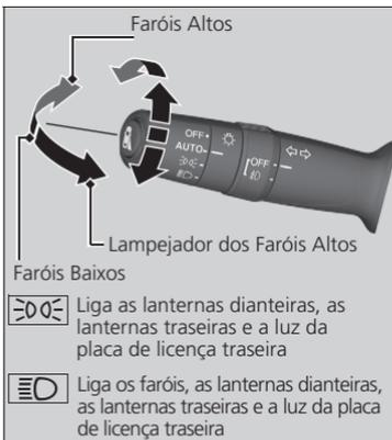
Ao girar o interruptor das luzes, as luzes se acendem e se apagam, independentemente da definição do modo de alimentação.
