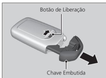
A chave embutida interna pode ser usada para travar/destravar as portas, quando a bateria do controle remoto de acesso sem chave estiver com pouca carga e a operação de travamento/destravamento das portas estiver desativada.
