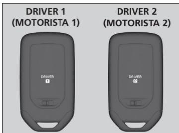
Ao entrar no veículo, a interface de informações ao motorista exibirá brevemente qual controle remoto você usou para destravar o veículo.
