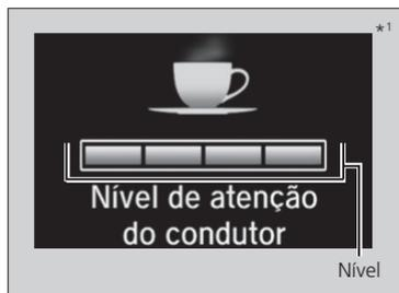
Ao selecionar **Atenção Condutor\*1** na interface de informações ao motorista, as barras se acendem na cor branca para indicar o nível de atenção do condutor.
