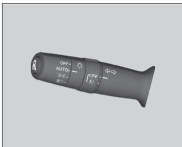
O controle de iluminação automática pode ser usado quando o modo de alimentação estiver definido para o modo **LIGADO**.
