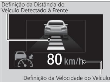
Quando o ACC com Assistente de Condução em Baixa Velocidade começar a funcionar, o ícone do veículo, as barras da distância definida do veículo detectado à frente e a velocidade definida, aparecem na interface de informações ao motorista. Durante o uso do ACC com Assistente de Condução em Baixa Velocidade, a Função de Assistência para Condução em Linha Reta [função do EPS (Sistema de Direção com Assistência Elétrica Progressiva)] é ativada.
