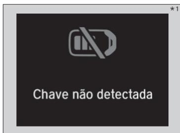
Quando o modo de alimentação for definido para qualquer modo diferente de **VEÍCULO DESLIGADO** e o controle remoto de acesso sem chave for retirado do veículo e a porta for fechada, um sinal sonoro de advertência soará. Se o sinal sonoro de advertência continuar a soar, coloque o controle remoto de acesso sem chave em um outro local.
