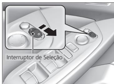
Se ativado, o espelho retrovisor externo do lado do passageiro inclina automaticamente para baixo ao mudar o botão seletor para a posição **R**; isto melhora a visibilidade do lado do passageiro quando estiver manobrando o veículo em marcha a ré. O espelho retrovisor retorna automaticamente para a posição original ao mudar o botão seletor para uma posição diferente de **R**.
