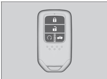
Use o controle remoto de acesso sem chave para ligar e desligar o sistema de alimentação e, para travar e destravar todas as portas, a portinhola de abastecimento de combustível e, para abrir o porta-malas.
