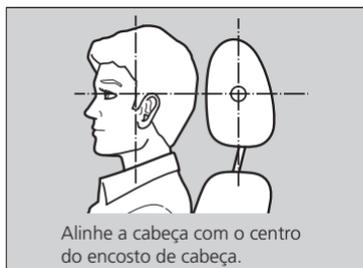
Os encostos de cabeça serão mais eficientes para proteção contra ferimentos em impactos traseiros quando o centro da parte posterior da cabeça do ocupante estiver apoiado no centro do encosto. As partes superiores das orelhas dos ocupantes devem estar niveladas com o encosto de cabeça.
