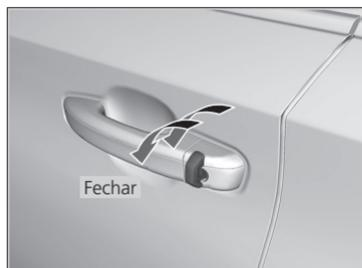
**Para fechar:** Trave a porta do motorista com a chave embutida. Dentro de 10 segundos após retornar a chave embutida à posição central, gire a chave embutida na direção de travamento e segure-a nesta posição.
