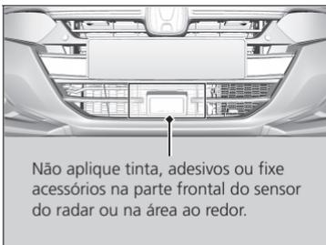
O sensor do radar está localizado na parte inferior do para-choque dianteiro.
