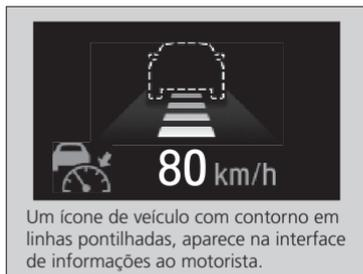
Seu veículo mantém a velocidade definida sem a necessidade de acionar o pedal de freio ou o pedal do acelerador.
