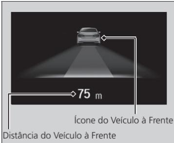
Exibe a distância entre o seu veículo e o veículo detectado à frente.
