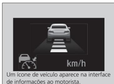
Quando um veículo cuja velocidade é mais lenta que a velocidade definida for detectado à sua frente, seu veículo começa a reduzir a velocidade.
