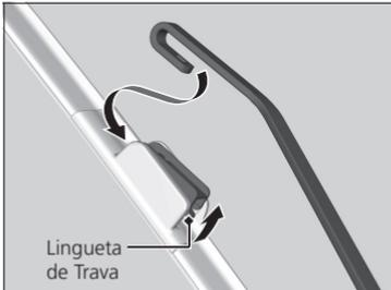
2. Pressione e segure a lingueta de trava e, em seguida, deslize a palheta para fora da haste do limpador.
