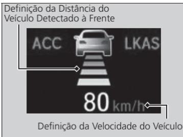
Quando o ACC com LSF começar a funcionar, o ícone do veículo, as barras da distância definida do veículo detectado à frente e a velocidade definida, aparecem na interface de informações ao motorista.
