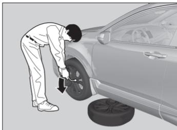
7. Solte as porcas da roda em aproximadamente uma volta, usando a chave de roda.
