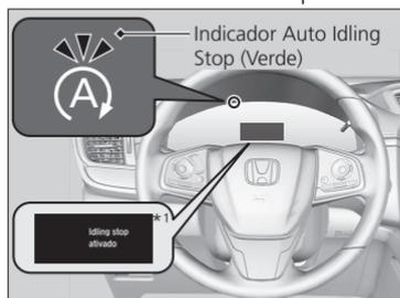
O motor entra em funcionamento novamente assim que o veículo estiver prestes a se mover novamente. O indicador Auto Idling Stop (Verde) se apaga.
