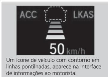
Seu veículo mantém a velocidade definida sem a necessidade de acionar o pedal de freio ou o pedal do acelerador.
