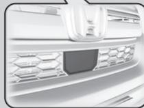
O sensor do radar está na parte interna da grade dianteira.
