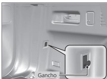
O gancho para bagagem no lado do motorista do compartimento de bagagem pode ser utilizado para pendurar itens leves.
