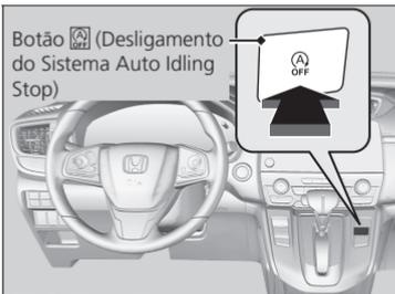
Pressione o botão para desligar o sistema Auto Idling Stop. O sistema Auto Idling Stop é desligado.
