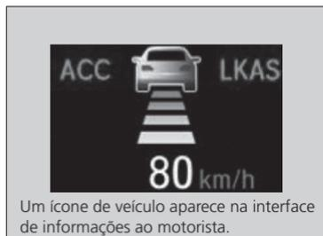
Quando um veículo cuja velocidade é mais lenta que a velocidade definida, se aproxima ou entra à sua frente e for detectado pelo radar e pela câmera, seu veículo começa a desacelerar.
