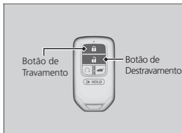
**Para abrir:** Pressione o botão de destravamento e, em seguida, dentro de 10 segundos, pressione-o novamente e mantenha-o pressionado. Se os vidros pararem no meio do percurso, repita o procedimento.
