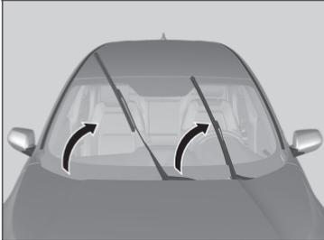
1. Levante primeiro a haste do limpador do lado do motorista e, em seguida, do lado do passageiro.
