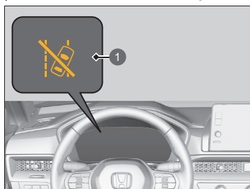
1 Indicador de Desligamento Automático do Sistema RDM (Sistema de Atenuação de Saída de Faixa de Tráfego)*
