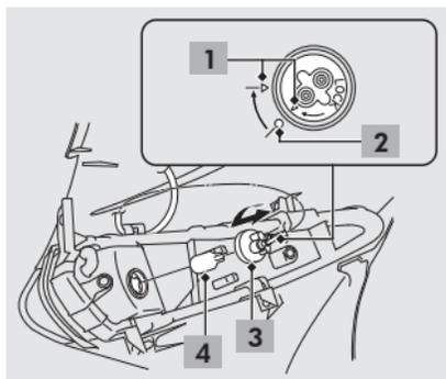
4. Instale a nova lâmpada e as demais partes na ordem inversa da remoção.
