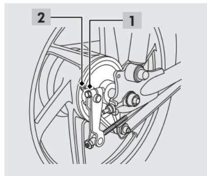
**Inspeção das sapatas do freio traseiro**
