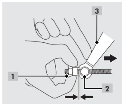
Empurre o braço do freio (3) para confirmar se há folga entre a porca de ajuste (1) e o pino do braço do freio (2).
