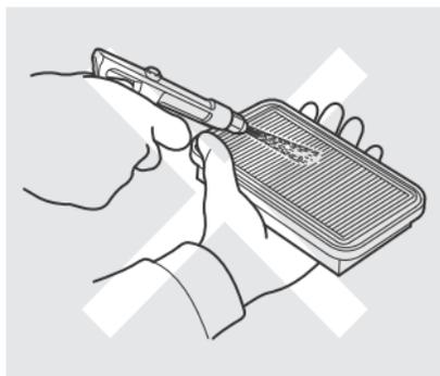
Esta motocicleta está equipada com filtro de ar úmido (tipo viscoso). Nunca limpe ou aplique jato de ar, pois isso danificará o filtro de ar e causará a entrada de poeira. A única manutenção necessária é a sua substituição de acordo com a tabela de manutenção. O filtro de ar deve ser substituído em uma concessionária Honda nos intervalos especificados na tabela de manutenção.
