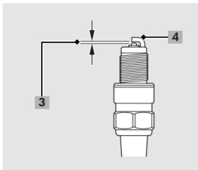
3. Inspeção os eletrodos e a porcelana central quanto a depósitos, erosão ou carbonização. Se forem excessivos, troque a vela. Para limpar velas carbonizadas, use um limpador de velas ou escova de aço.
