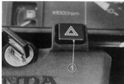
(1) Interruptor do sinalizador de advertência
