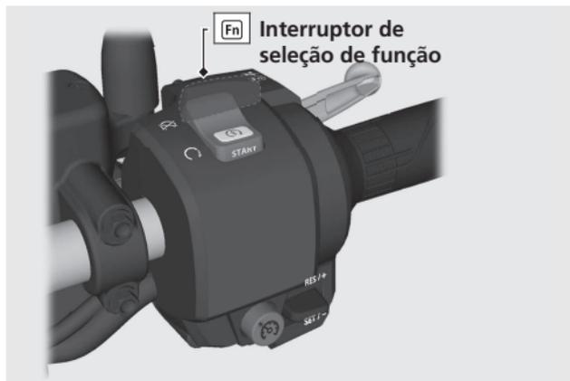
3. Mova para frente ou para trás a alavanca de função **[Fn]** para selecionar o nível do aquecedor das manoplas.
