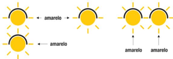
No caso de grupo focal de regulamentação, admite-se o uso isolado da indicação luminosa em amarelo intermitente, em determinados horários e situações específicas. Fica o condutor do veículo obrigado a reduzir a velocidade e respeitar o disposto no Artigo 29, inciso III, alínea C.
