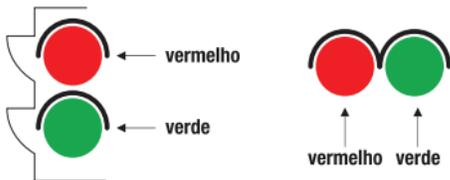
Com símbolos, que podem estar isolados ou integrando um semáforo de três ou duas indicações luminosas.
