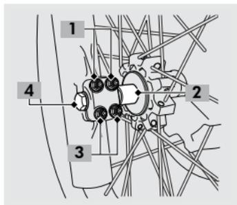
1. Porcas superiores de fixação do suporte do eixo dianteiro
