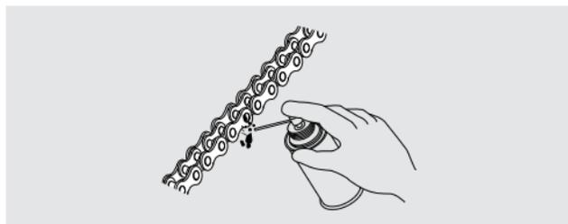
Não utilize máquinas de limpeza de alta pressão, escova de aço, solvente volátil, como gasolina e benzeno, produto de limpeza abrasivo, produto de limpeza ou lubrificante não projetado especificamente para as correntes com O-ring, pois estes podem danificar os O-rings de vedação.
