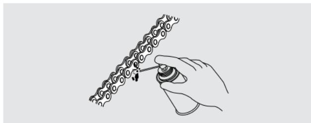
Não utilize máquinas de limpeza de alta pressão, escova de aço, solvente volátil, como gasolina e benzeno, produto de limpeza abrasivo, produto de limpeza ou lubrificante não projetado especificamente para as correntes com O-ring, pois estes podem danificar os O-rings de vedação.
