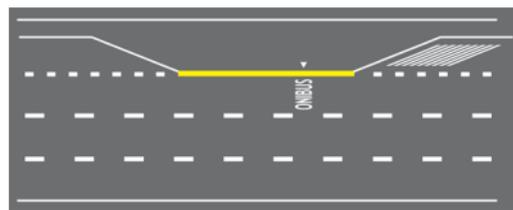
❖ MARCA DELIMITADORA DE ESTACIONAMENTO REGULAMENTADO
