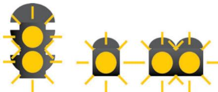
FUNCIONAMENTO INTERMITENTE OU PISCANTE ALTERNADO,
