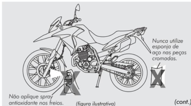
5. Logo após a lavagem, lubrifique a corrente de transmissão e os cabos do acelerador e da embreagem. Aplique spray antioxidante nas rodas, amortecedores, interior e exterior do escapamento e demais peças cromadas.
