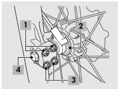
1. Porcas superiores de fixação do suporte do eixo dianteiro
