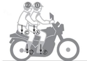
Distribua a soma dos pesos uniformemente entre A (assento dianteiro), B (pedal de apoio dianteiro), C (assento traseiro) e D (pedal de apoio traseiro).
