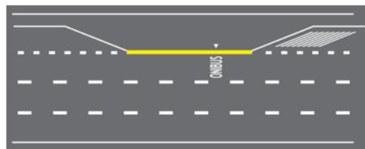
❖ MARCA DELIMITADORA DE ESTACIONAMENTO REGULAMENTADO
