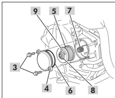
3. Remova os parafusos (3) e a tampa do filtro (4). Em seguida, retire o filtro de óleo (5) da tampa.
