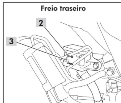
2. Adicione fluido, se necessário. Se o nível estiver baixo, inspecione também o desgaste das pastilhas (pág. 6-18). Se estiverem em bom estado, verifique se há vazamentos.
