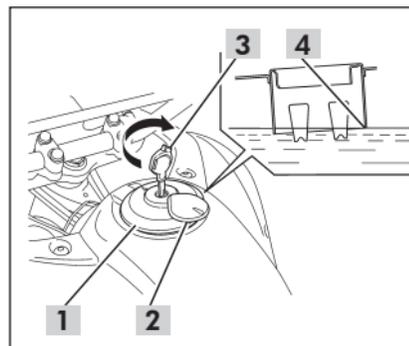
Para abrir a tampa (1), abra a capa da fechadura (2), insira a chave de ignição (3) e gire-a no sentido horário. A tampa será levantada.
