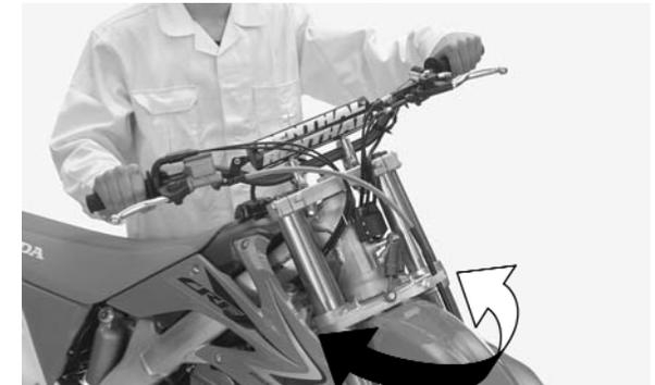
4. Instale a placa de numeração (3) alinhando os orifícios (7) com as lingüetas (8) na coluna de direção. Instale e aperte os parafusos (2) firmemente. Coloque a alça da placa de numeração (1) em volta da almofada do guidão (9) como mostrado.
