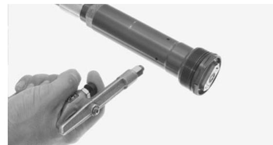
16. Caso não haja ar comprimido disponível, remova o parafuso de liberação de pressão (10) localizado no parafuso superior do garfo. Mantenha o amortecedor do garfo invertido por 10 minutos e drene o óleo da câmara da mola do amortecedor do garfo.
