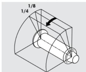
Gire o acelerador 1/8 a 1/4 de volta durante a partida do motor.
