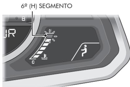
Quando a temperatura do líquido de arrefecimento está acima da temperatura especificada, o 6° (H) segmento pisca e o indicador de temperatura alta do líquido de arrefecimento se acende.
