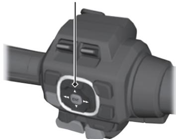
Para operar utilizando o interruptor de 4 direções no guidão esquerdo:
