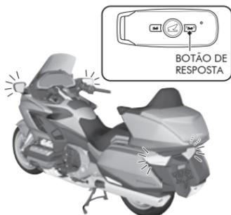
O sistema de resposta é um dispositivo útil para localizar sua motocicleta e informá-lo de que a função do imobilizador da Honda SMART Key está ativada.
