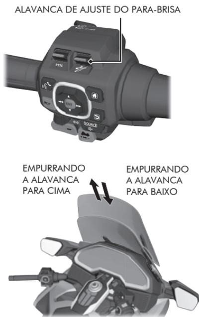
Posicione o interruptor de ignição em **I** (Ligado). Ao pilotar em velocidades acima de 5 km/h, o para-brisa se ajustará automaticamente para a posição que estava quando o interruptor de ignição foi colocado da última vez em **O** (Desligado).
