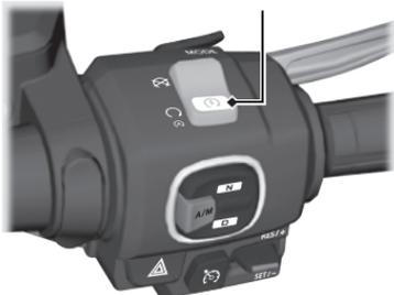
Ative ou desative o Sistema Idling Stop utilizando o interruptor de partida/ Idling Stop ou ajustando o menu no mostrador Multifunção. (Pág. 33)
