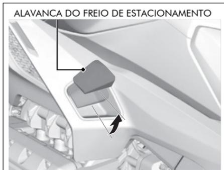
Estacione a motocicleta em uma superfície nivelada. Desligue o motor e empurre a motocicleta enquanto aciona o freio de estacionamento para verificar a eficácia do freio de estacionamento.
