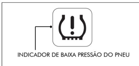
Observe que o TPMS não substitui a manutenção adequada do pneu. Portanto, é responsabilidade do proprietário manter a pressão correta do pneu, mesmo que a pressão do pneu não seja tão baixa a ponto do indicador de baixa pressão dos pneus se acender.
