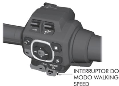
4. Pressione o interruptor do modo Walking Speed enquanto aplica a alavanca ou o pedal do freio. O indicador do modo Walking Speed será exibido.
