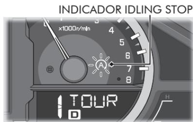
O motor é desligado e o indicador Idling Stop pisca após fechar o acelerador completamente e parar a motocicleta enquanto o sistema Idling Stop estiver ativado.
