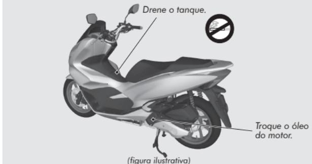
4. Para impedir oxidação no interior do cilindro:
