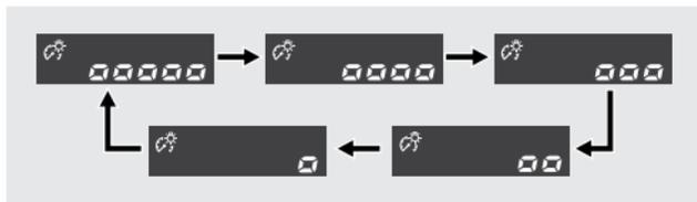
3. Pressione o botão **SET**. O brilho do painel de instrumentos está definido e, em seguida, o mostrador muda para a alteração da unidade do medidor de consumo de combustível. (A unidade do medidor de consumo de combustível para de piscar).
