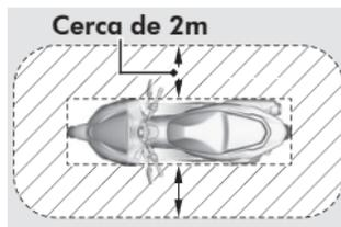
Qualquer pessoa em posse da Honda SMART Key pode ligar o motor, destravar o interruptor de ignição, destravar o assento, abrir a portinhola do tanque de combustível e destravar a coluna de direção, se a Honda SMART Key estiver dentro do alcance operacional. Você deve sempre estar em posse da Honda SMART Key ao iniciar ou finalizar a pilotagem.
