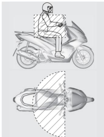
Qualquer pessoa pode desbloquear o interruptor de ignição e ligar o motor se a Honda SMART Key estiver dentro do alcance operacional da motoneta, mesmo se você estiver do outro lado de uma parede ou janela. Se você estiver longe de sua motoneta, mas a Honda SMART Key ainda estiver dentro do alcance operacional, desative o sistema Honda SMART Key.
