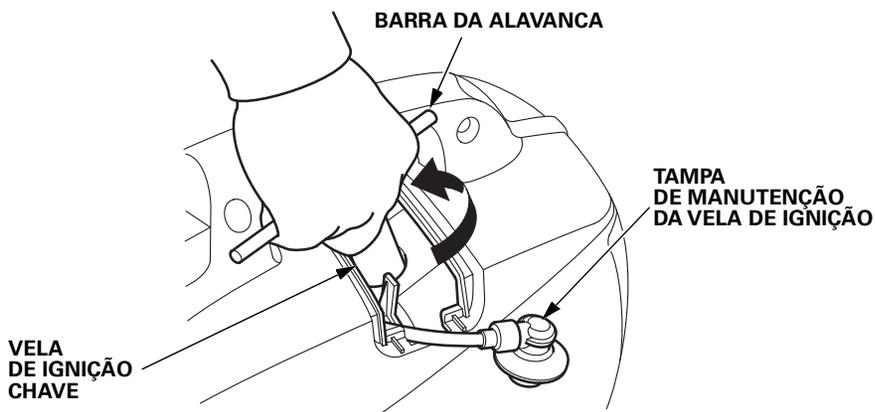
5. Inspeção visualmente a vela de ignição. Substitua-a se o isolante estiver trincado, lascado ou queimado. Se a vela de ignição puder ser reutilizada, limpe-a com uma escova de aço.
