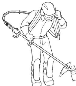
3. Ajuste o comprimento da alça de transporte de forma que seu apoio fique posicionado firmemente contra suas costas e que o peso da unidade fique distribuído uniformemente sobre seus ombros.
