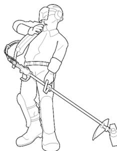
2. Segure o guidão com a mão direita e com a mão esquerda coloque a alça de transporte esquerda sobre seu ombro esquerdo.
