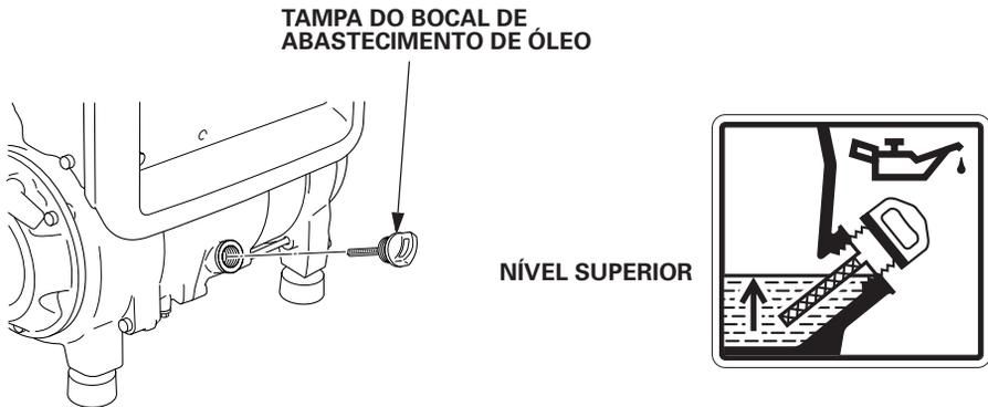
O sistema de alerta de óleo interromperá automaticamente o motor antes que o nível de óleo fique abaixo dos limites de segurança. Entretanto, para evitar a inconveniência de uma interrupção inesperada, verifique o nível de óleo regularmente.
