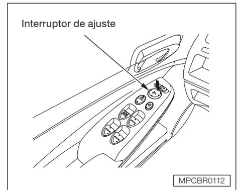
3. Pressione o lado correspondente do interruptor de ajuste para mover o espelho para cima, para baixo, para o lado esquerdo ou para o lado direito.
