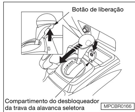
6. Remova a chave do compartimento do desbloqueador da trava da alavanca seletora, em seguida recoloca a tampa. Certifique-se que o entalhe da trava está do lado da alavanca seletora. Pressione o pedal do freio e dê a partida no motor.
