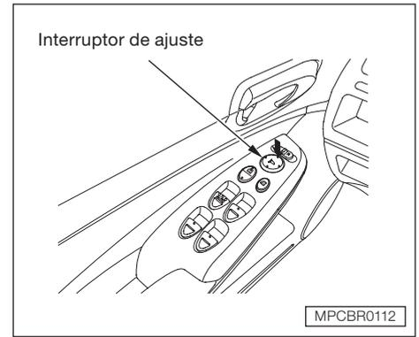
3. Pressione o lado correspondente do interruptor de ajuste para mover o espelho para cima, para baixo, para o lado esquerdo ou para o lado direito.
