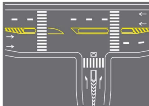
❖ **MARCAS DE DELIMITAÇÃO E CONTROLE DE ESTACIONAMENTO E/OU PARADA (PARA ÁREAS ONDE É PROIBIDO OU REGULAMENTADO O ESTACIONAMENTO E A PARADA DE VEÍCULOS)**
