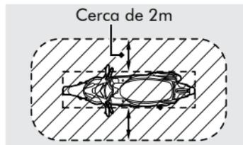
Qualquer pessoa pode desbloquear o interruptor de ignição e ligar o motor se a Honda SMART Key estiver dentro do alcance operacional da motoneta, mesmo se você estiver do outro lado de uma parede ou janela. Se você estiver longe de sua motoneta, mas a Honda SMART Key ainda estiver dentro do alcance operacional, desative o sistema Honda SMART Key.
