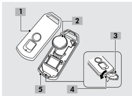
2. Substitua a bateria antiga por uma nova bateria com o lado negativo (-) voltado para cima.
