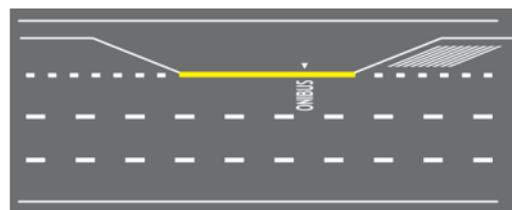
❖ MARCA DELIMITADORA DE ESTACIONAMENTO REGULAMENTADO
