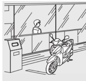
Qualquer pessoa em posse da Honda SMART Key pode ligar o motor, destravar o interruptor de ignição, destravar o assento e destravar a coluna de direção, se a Honda SMART Key estiver dentro do alcance operacional.
