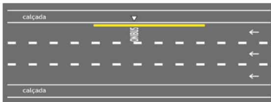
**MARCA DELIMITADORA PARA PARADA DE ÔNIBUS EM FAIXA DE ESTACIONAMENTO**
