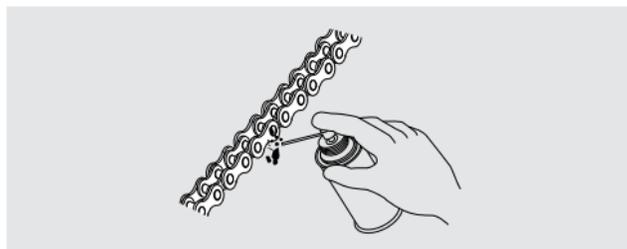
Não utilize equipamentos de limpeza a vapor ou de alta pressão, escovas de aço, solventes, tais como gasolina ou benzina, produtos de limpeza abrasivos, limpadores ou lubrificantes não específicos para correntes com O-rings, pois eles podem danificar os O-rings de vedação.
