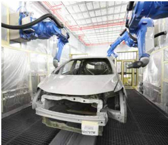
Cabina de Pintura
